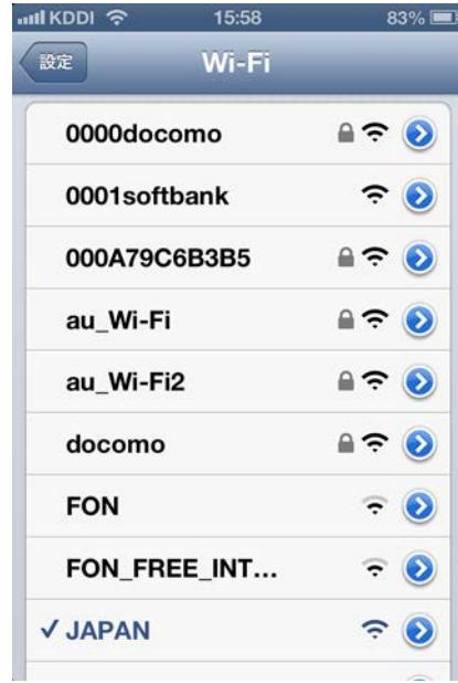
図 3 災害用統一 SSID「JAPAN」
